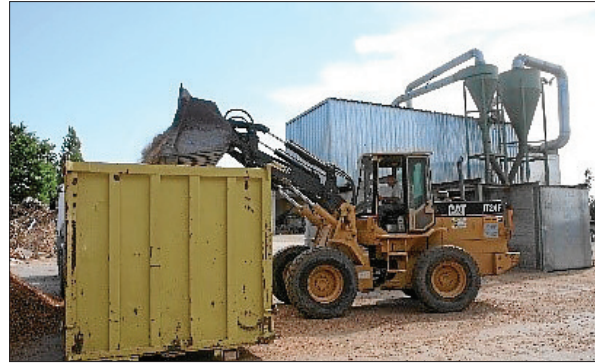
Pala carregadora introduint estella forestal dins un contenidor. (Autor: M. Esgleyes i Cadanet)
